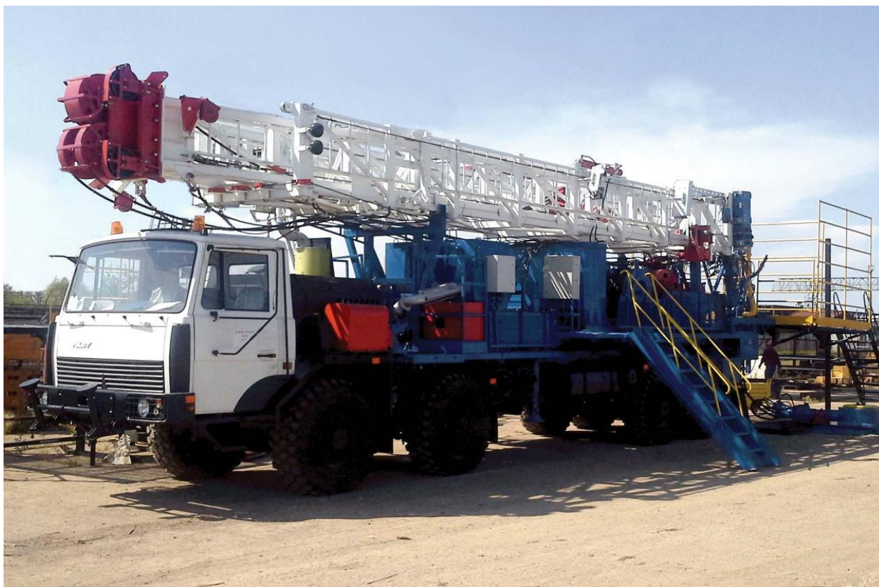
Рисунок 5 - Общий вид станка для капитального ремонта скважин
